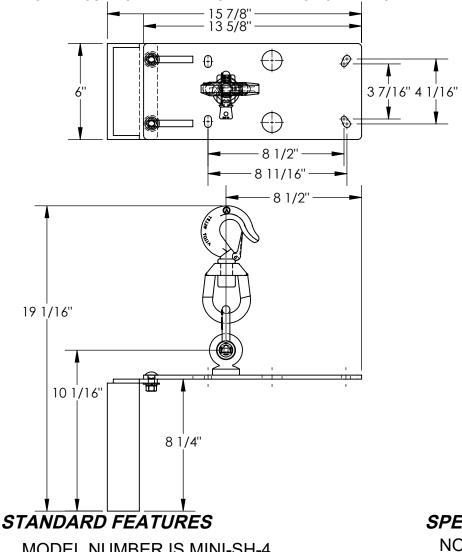
MODEL NUMBER IS MINI-SH-4 **OVERALL WIDTH IS 6"** MAX OVERALL LENGTH IS 15 7/8" MIN OVERALL LENGTH IS 13 5/8" **OVERALL HEIGHT IS 19 1/16"** MAX CAPACITY IS 880 LBS. MINI ADAPTOR PLATE FOR USE WITH MINI-4 MOVE COUNTER WEIGHT TO LEVEL THE HOIST **INCLUDES SHACKLE & HOOK** TOUGH BAKED IN POWDER COATED BLACK FINISH
